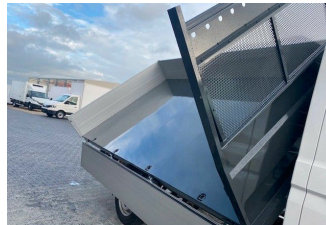
Kabinenschutz aus Stahl mit Leitfänger
