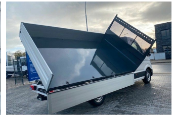
Stahlboden glatt mit Zurrösen Links und Rechts
