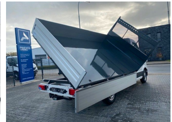
Stahlboden glatt mit Zurrösen Links und Rechts
