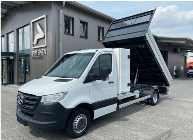
Mercedes-Benz Sprinter 516 mit neuem Dreiseitenkipper und einer Werkzeugkiste zwischen Kabine und Aufbau
